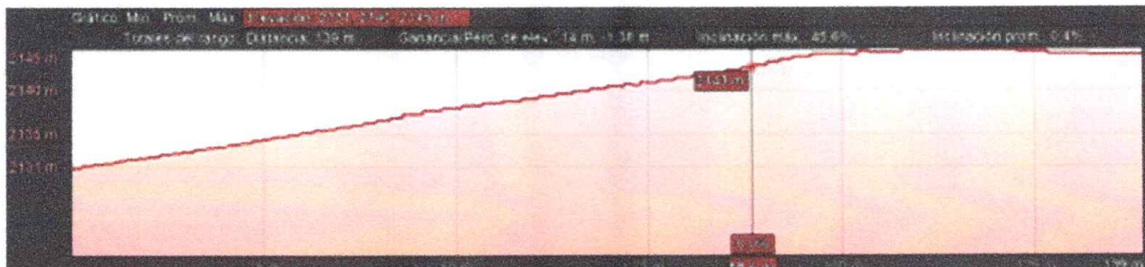
Imagen 11. Localización, registro fotográfico y perfil (mayor al 7%) Placa huella vía Vereda Santa Teresa– Vereda Mundo Nuevo, Sector La Yee, tramo 130 metros lineales
