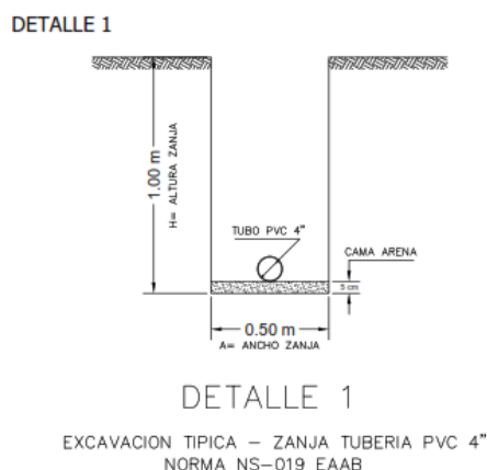
Ilustración 1 Plano de perfil excavación tubería – fuente: propia
