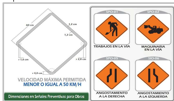
Señal SP0-01 (trabajos en la vía).
