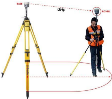
Ilustración 2 Esquema en campo de la metodología RTK. Fuente: Geocom
