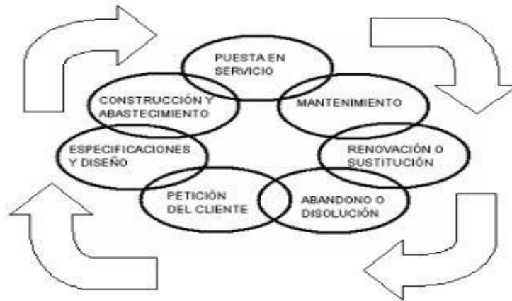
Figura 1. Fases clave de la cadena de suministro en construcción
